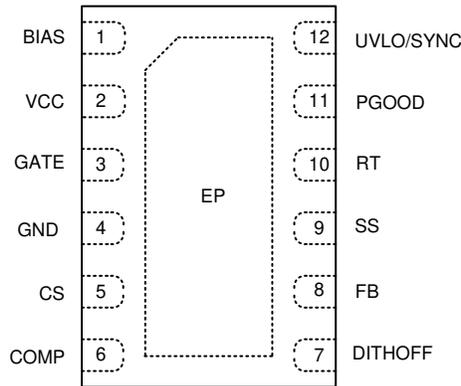
图 7-1. 12-Pin WSON DSS Package (Transparent Top View)
