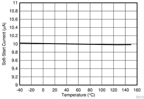
图 8-13. I<sub>SS</sub> vs Temperature
